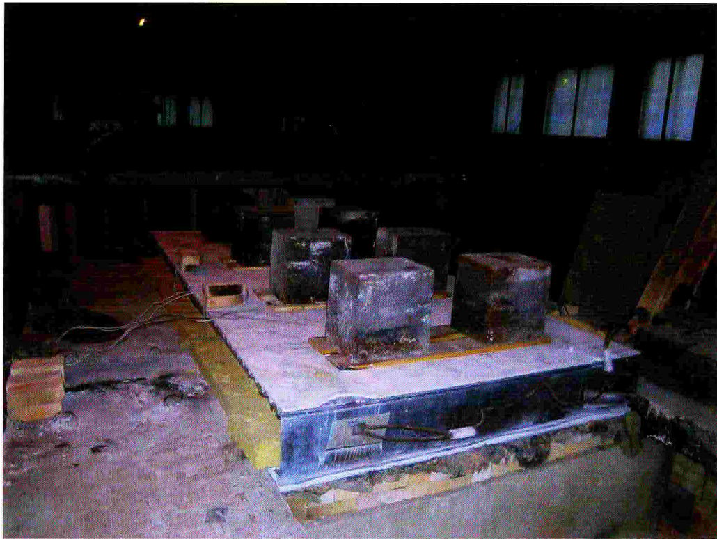
Рис. 2. Опытный образец № 1 с приложенной равномерно-распределенной нагрузкой.
