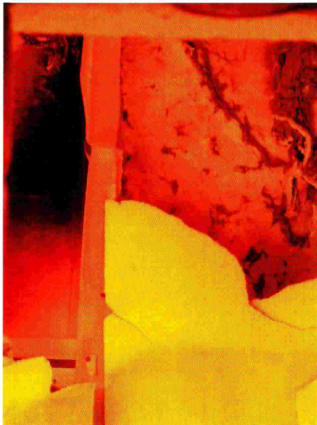
Рис. 5. Обрушение 2-го (внутреннего) слоя листов ГВЛ, а также оплавление и выпадение теплоизоляционного слоя (образец № 1, вид в смотровое окно).
