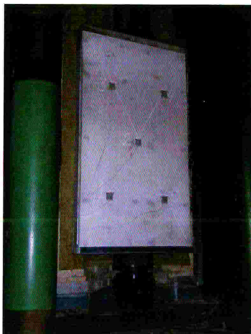
Рис. 2. Опытный образец № 1 установленный на экспериментальную установку перед огневым испытанием.
