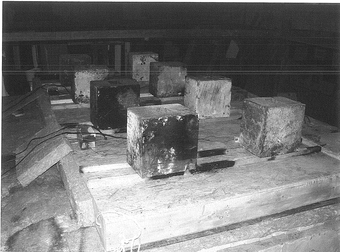
Фото 2. Опытный образец перекрытия № 2 перед проведением испытания
