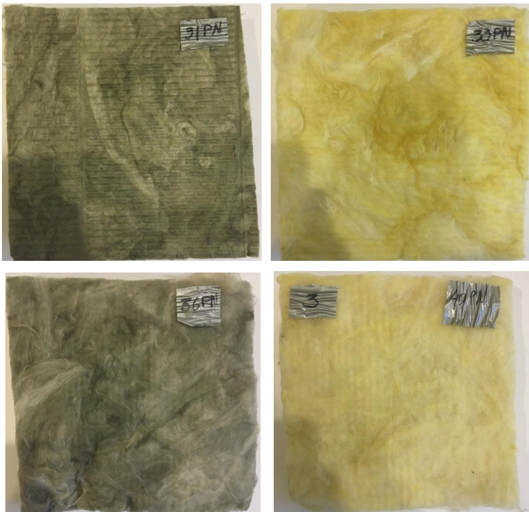
Рис. 5 Вид образцов минеральной изоляции URSA после испытаний
