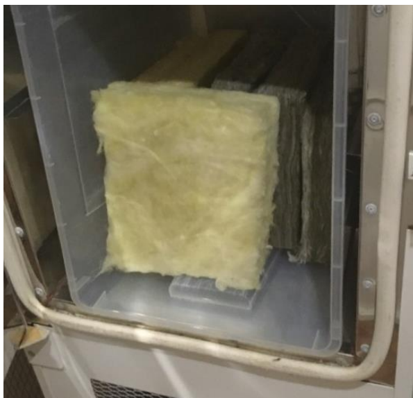
Рис. 2 Фото образцов минеральной изоляции в климатической камере перед началом испытаний
