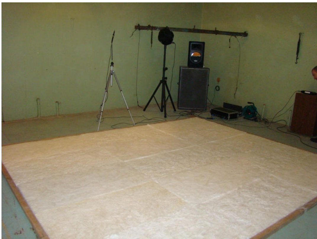
Рис.1. Измерения диффузных коэффициентов звукопоглощения в реверберационной камере.
