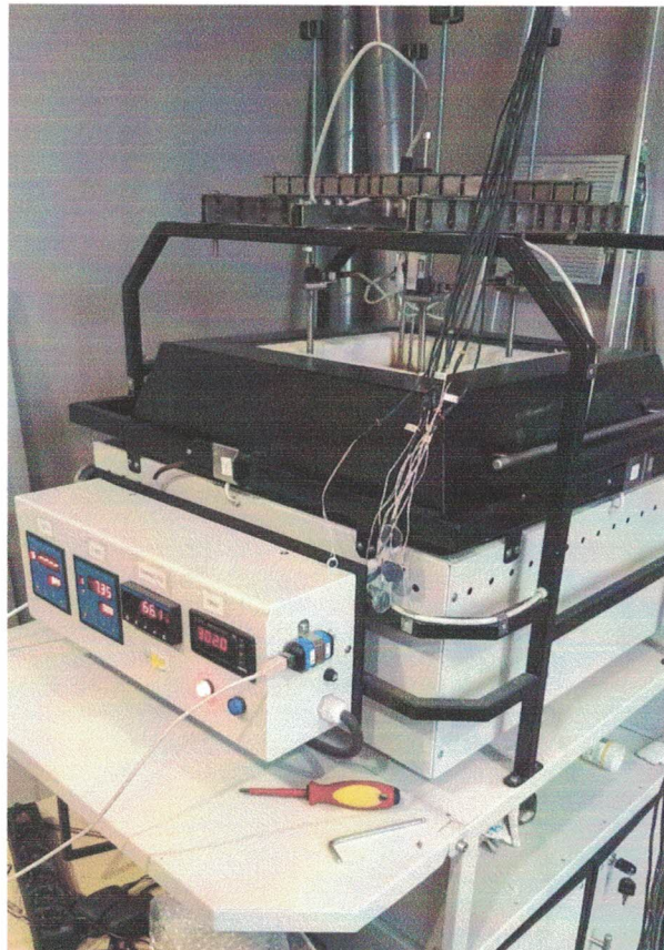
Рис. 1 Экспериментальная установка по определению максимальной рабочей температуры
