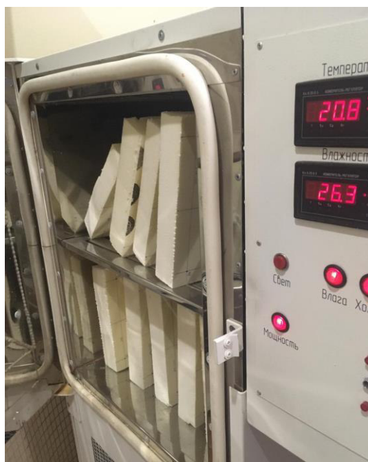
Рис. 2 Образцы в климатической камере перед испытаниями
