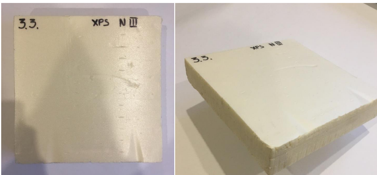
Рис. 11 Опытные образцы URSA XPS N III после испытаний
