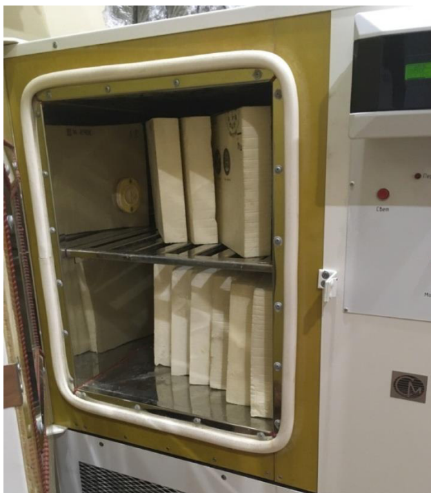
Рис. 6 Образцы в климатической камере в процессе испытаний
