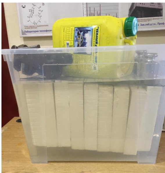
Рис. 5 Процесс увлажнения при полном погружении образцов
