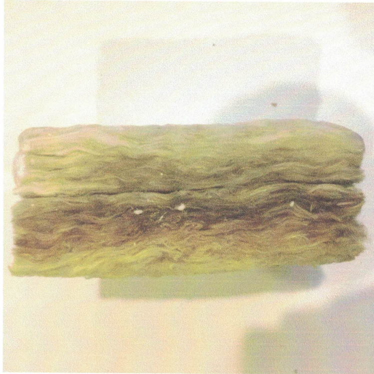
Рис.8 Фотография боковой грани образца после испытаний
