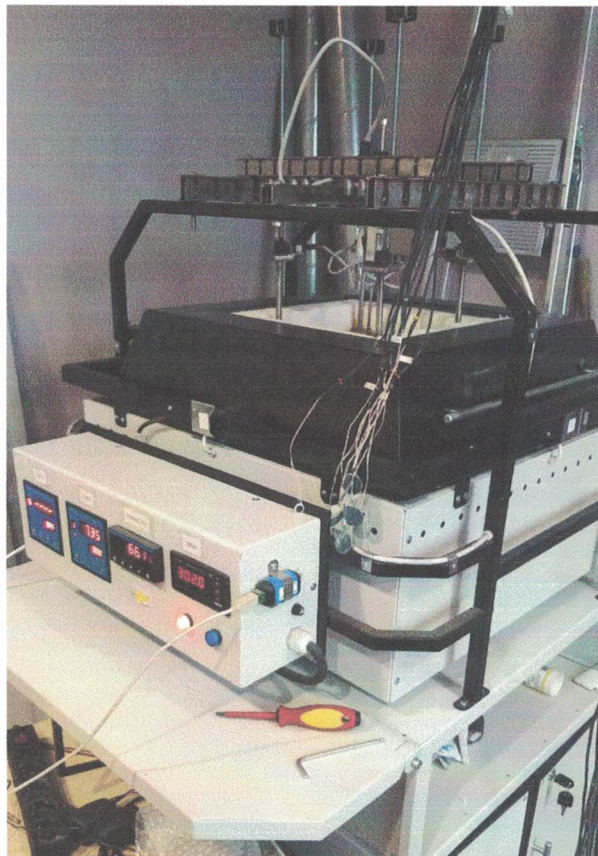
Рис. 1 Экспериментальная установка по определению максимальной рабочей температуры
