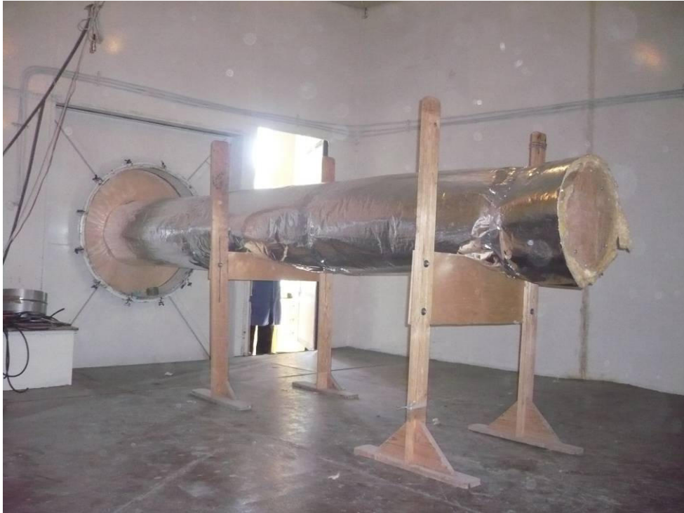
Рисунок 2.5 – Испытательная труба диаметром 315 мм с покрытием марки URSA GEO M-25Ф, \delta=100 мм
