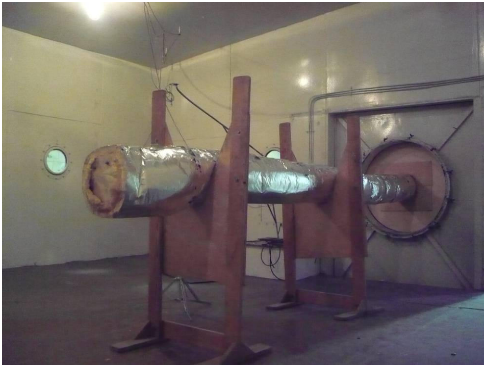
Рисунок 2.4 – Испытательная труба диаметром 160 мм с покрытием марки URSA GEO M-25Φ, \delta=100 мм
