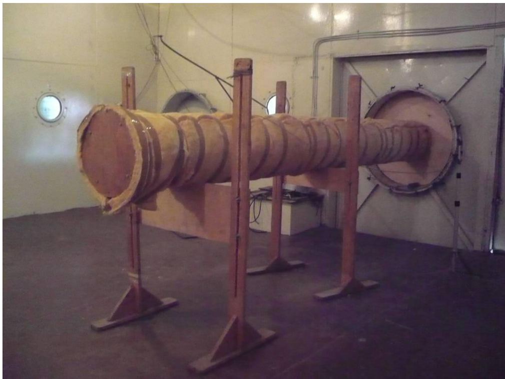
Рисунок 2.6 – Испытательная труба диаметром 315 мм с покрытием марки URSA GEO M-25, \delta=50 мм
