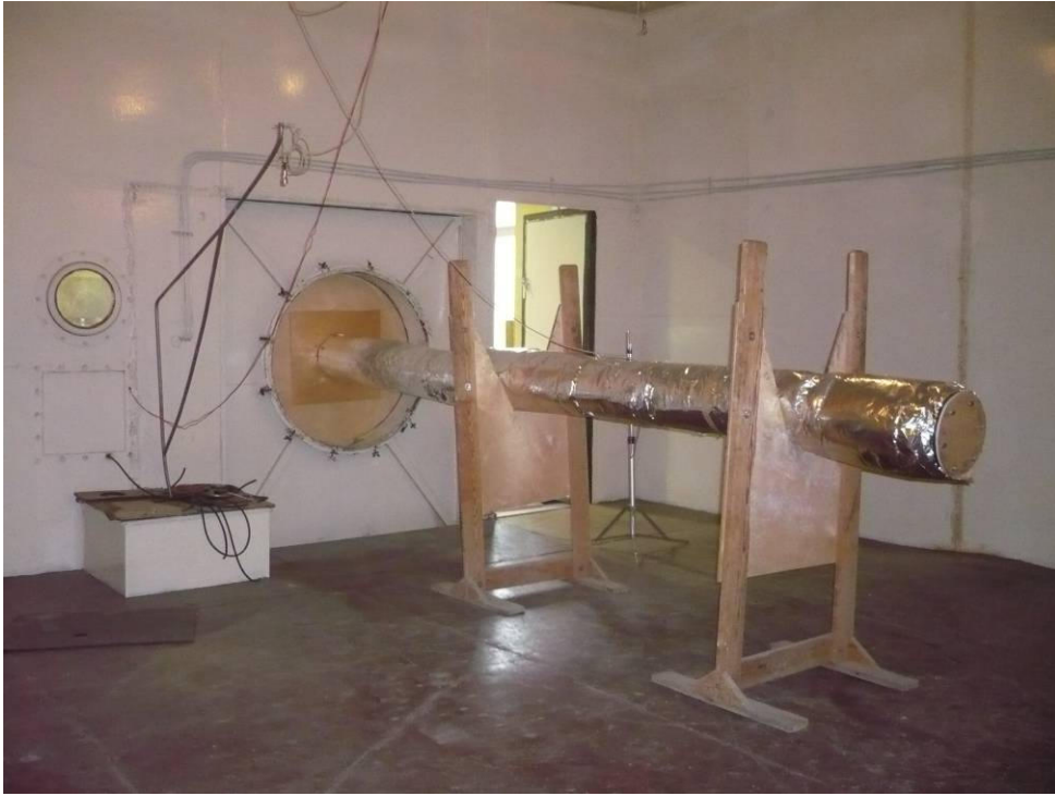
Рисунок 2.3 – Испытательная труба диаметром 160 мм с покрытием марки URSA GEO M-25Φ, \delta=50 мм
