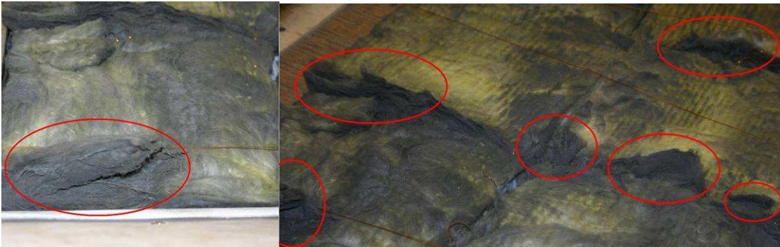
Рис.7.7. Отделение слоев образцов (места отслоения обведены красным).
