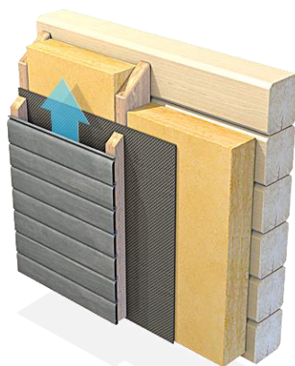
Рисунок 1. Конструкция дополнительного утепления наружных стен из бруса Слева-направо: сайдинг, вентилируемый воздушный зазор, ветрозащитная мембрана, теплоизоляция, установленная в каркас, стена из бруса
