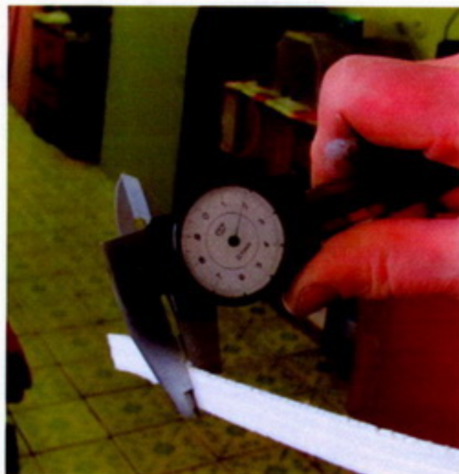
Рисунок 6 – Процесс измерения толщины нанесенного теплоизоляционного покрытия
